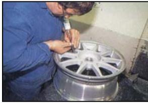
Un contrôle visuel est réalisé sur toutes les jantes. On élimine ici les dernières bavures d'alliage, grâce à un ponçage ou à un léger coup de fraise.
