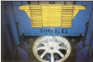
Avant la mise en fabrication d'une jante, elle subit des tests de résistance, de fatigue du métal, d'écrasement.
