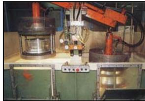
La jante passe ensuite un test d'étanchéité dans des bacs spéciaux. Les fuites éventuelles seront détectées par les bulles formées par l'air qui s'échappe.
